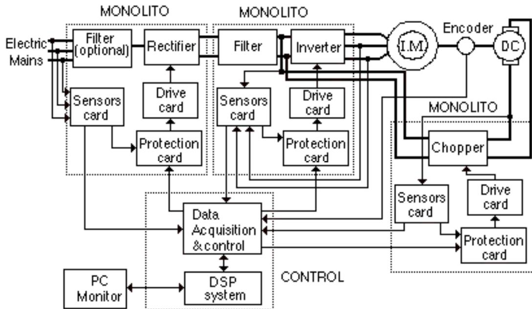
Fig. 1.- PLATAFORMAIII Block Diagram.
